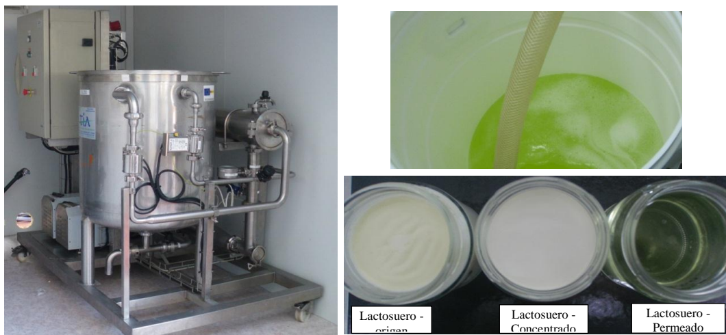
Figura 1: Ensayos de ultrafiltración. a) Vista general, b) retentado, c) permeado
